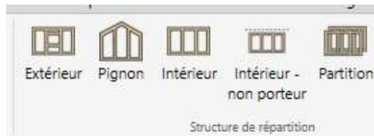
L'outil Créer le panneau ossature créera des panneaux "Intérieur - non porteur" lorsque le mur gris sélectionné est un mur intérieur.
